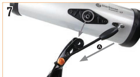
Fare scorrere l'asta dell'altitudine **A** nella relativa guida sulla montatura e abbassare i mozzetti dell'altitudine sul tubo del telescopio negli agganci in cima a ciascun braccio.
