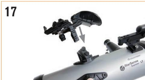
**17** Lösen Sie zum Installieren des StarSense Smartphone-Docks die beiden Stellschrauben an der Dockmontierung oben am Teleskoptubus und schieben Sie den Schwalbenschwanz unten am Dock in die Montierung. Sichern Sie ihn, indem Sie beide Schrauben festziehen.
