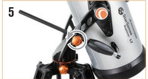
La tige de mouvement lent dispose d'une plage de mouvement limitée d'environ 15 degrés. Lorsque vous arrivez en bout de la course permise par la molette et qu'elle ne peut plus tourner, vous pouvez la réinitialiser en desserrant la molette du guide de la tige et en tournant la poignée de la tige de mouvement ralenti dans la direction opposée jusqu'au milieu de sa course. Resserrez ensuite la molette du guide de la tige.
