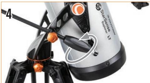
4 È possibile regolare in modo preciso la direzione verso l'alto e verso il basso mediante l'asta del movimento lento per l'altitudine. Mantenere bloccata la manopola della guida dell'asta e ruotare la leva nera dell'asta del movimento lento. Ciò permette di spostare il telescopio poco a poco per rendere più facile centrare gli oggetti o seguire i corpi celesti nel cielo.
