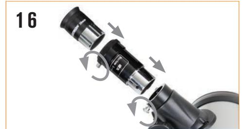
**16** Um die Barlowlinse zu verwenden, entfernen Sie das Okular vom Fokussierer des Teleskops, setzen Sie die Barlowlinse in der Fokussierer ein und stecken Sie das Okular in die Barlowlinse. Dies verdoppelt die Vergrößerung jedes Okulars, das Sie mit ihr verwenden.
