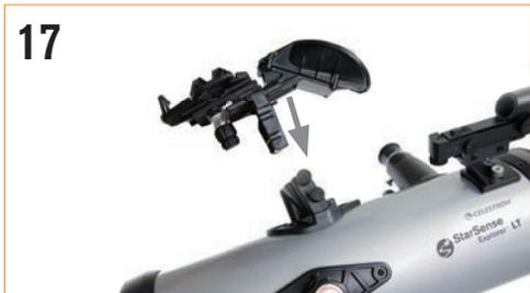
**17** Per installare l'aggancio per smartphone StarSense, allentare le due viti sulla montatura dell'aggancio in cima al tubo del telescopio e fare scorrere la coda di rondine sulla parte inferiore dell'aggancio sulla montatura. Fissare in posizione serrando entrambe le viti.
