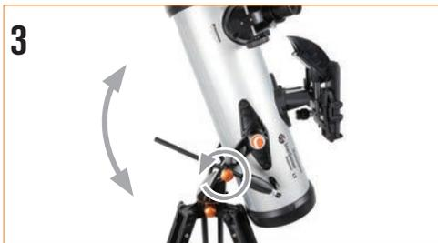
3 Per spostare il telescopio verso l'alto e verso il basso, tenere il foceggiatore del telescopio con una mano e allentare la manopola sulla guida dell'asta del movimento lento. Il telescopio può essere ora spostato verso l'alto e verso il basso a piacimento. Quando si è vicino all'oggetto, serrare la manopola per fissare il telescopio in posizione.
