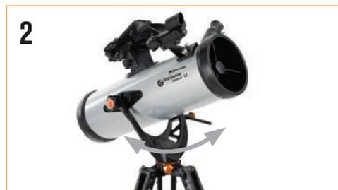
2 Tenere la gamba del treppiede con una mano e afferrare il foceggiatore del telescopio e spostarlo a sinistra o a destra come desiderato. Il grado di tensione percepito quando si sposta il telescopio può essere regolato serrando o allentando la manopola a un livello comodo per l'utente.
