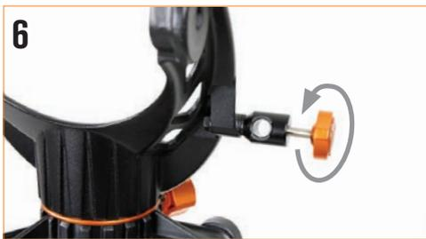
Desserrez la molette sur la tige-guide d'altitude, sur le côté de la monture à fourche, pour libérer le trou.
