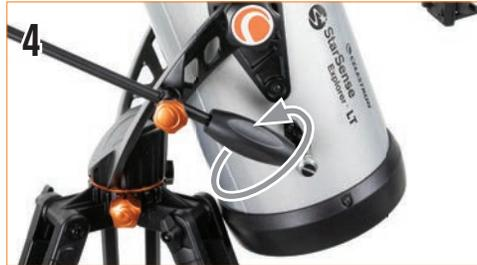
4 El ajuste preciso en dirección arriba y abajo puede realizarse con el mango de movimiento lento de altitud. Mantenga bloqueado el mando de la guía del mango y gire el mango negro del mango de movimiento lento. Podrá mover el telescopio en incrementos pequeños, para ayudarle a centrar objetos o seguir objetos celestes en el firmamento nocturno.
