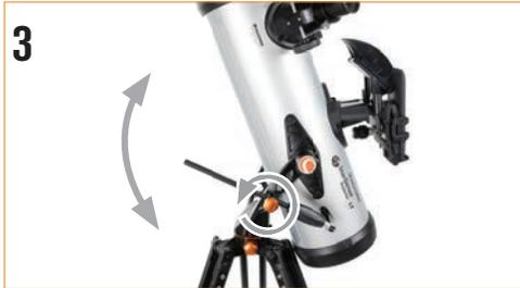
3 Para mover el telescopio arriba y abajo, aguante el enfoque del telescopio con una mano y afloje el mando de la guía del mango de movimiento lento. El telescopio podrá moverse arriba o abajo como desee. Cuando esté cerca de su objetivo, apriete el mando para asegurar el telescopio en posición.
