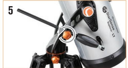
5 El mango de movimiento lento de altitud tiene un alcance de movimiento limitado, de aproximadamente 15 grados. Si llega al final del recorrido y el mando ya no puede girar más, puede restablecerlo aflojando el mando de guía del mango y girando el mango de movimiento lento en dirección opuesta hasta mitad de recorrido, y apretando de nuevo el mando de guía del mango.
