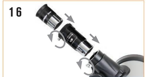
**16** Para usar la lente Barlow, saque el ocular del enfoque del telescopio, introduzca la lente Barlow en el enfoque e introduzca su ocular en la lente Barlow. Doblará el aumento del ocular con el que la use.
