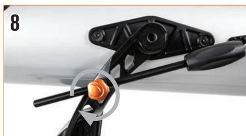
Serrare la vite della guida dell'asta dell'altitudine per mantenere in posizione il telescopio.
