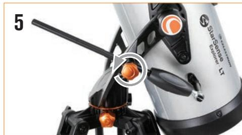
5 L'asta del movimento lento per l'altitudine ha un intervallo di movimento limitato di circa 15 gradi. Se si arriva al finecorsa e la manopola non può essere ulteriormente ruotata, è possibile ripristinarla allentando la manopola della guida dell'asta e ruotando la leva dell'asta del movimento lento in direzione opposta fino a quando non si torna a metà del percorso disponibile, quindi serrare nuovamente la manopola della guida dell'asta.
