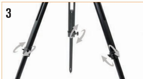
Allungare la parte centrale di ciascuna delle tre gambe del treppiede verso il basso di 15-30 cm. Usare la vite di fissaggio situata su ciascuna gamba per fissare la gamba allungata in posizione.
