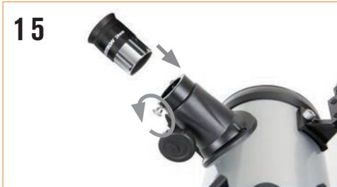
**15** Lösen Sie zum Installieren des Okulars die Stellschrauben am Fokussierer. Stecken Sie die silberfarbene Steckhülse am unteren Ende des Okulars in den Fokussierer und ziehen Sie die Stellschrauben fest. Verwenden Sie stets Ihr Okular mit geringer Vergrößerungsleistung (25 mm), um das gewünschte Ziel zu suchen. Sie können später jederzeit auf Ihr Okular mit hoher Vergrößerung (10 mm) umsteigen.
