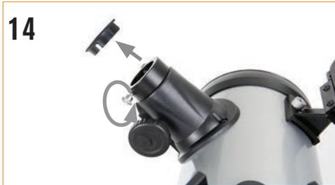
**14** Lösen Sie die Stellschrauben am Fokussierer des Teleskops und entfernen Sie die Staubschutzkappe.
