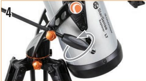
Vous pouvez régler l'orientation vers le haut et le bas finement à l'aide de la tige d'altitude à mouvement ralenti. Laissez la molette du guide de la tige serrée et faites pivoter la poignée noire sur la tige de mouvement ralenti. Cela vous permet d'orienter le télescope par petits incréments pour vous aider à centrer des objets ou à suivre des objets célestes dans le ciel nocturne.
