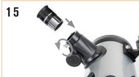
**15** Per installare l'oculare, allentare le viti sul focheggiatore. Inserire il barilotto color argento alla base dell'oculare nel focheggiatore e fissare serrando le viti. Iniziare sempre con l'Oculare basso indice di ingrandimento (25 mm) per agevolare l'identificazione dell'oggetto che si desidera osservare. È sempre possibile passare in un secondo momento a un oculare con maggiore potenza (10 mm).
