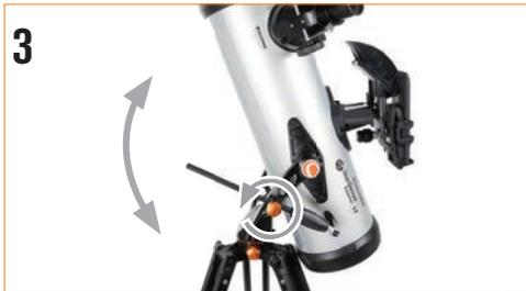
3 Um das Teleskop auf- und abwärts zu bewegen, halten Sie den Fokussierer des Teleskops mit einer Hand und lösen Sie den Knopf an der Zeitlupeführungsstange. Das Teleskop kann nun wie gewünscht nach oben oder unten bewegt werden. Wenn Sie sich Ihrem Ziel nahe sind, ziehen Sie den Knopf fest, um das Teleskop zu sichern.
