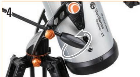
4 Die Feineinstellung in Auf- und Abwärtsrichtung kann mit der Zeitlupe Stange für die Höhe erfolgen. Lassen Sie den Stabführungsknopf verriegelt und drehen Sie den schwarzen Griff an der Zeitlupe Stange. Auf diese Weise können Sie das Teleskop in kleinen Schritten bewegen, um Objekte zu zentrieren oder Himmelsobjekten am Nachthimmel zu folgen.
